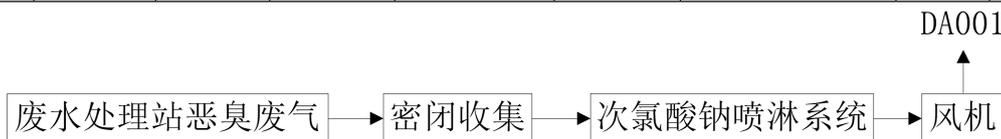
图 4-1 项目废气处理工艺流程图
